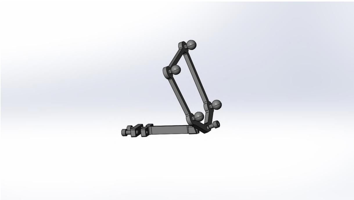
*Рисунок 13 – Схема сборки инструментальной системы сфер на универсальном креплении*
